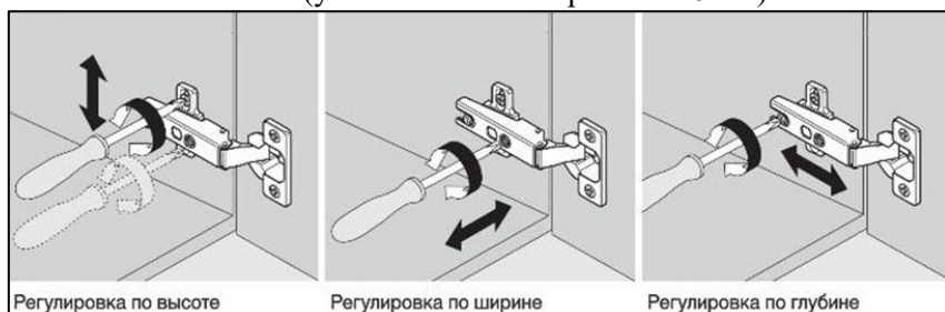
Рис. 1 Установка петель (установка на саморезы 4x16 мм)
