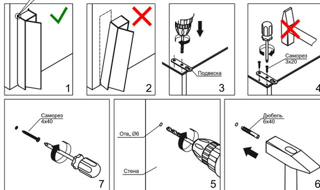
Во избежание опрокидывания изделия во время эксплуатации закрепить его к стене (см. схемы 1, 2). Для разных материалов стен требуются различные крепления, используйте крепёжные средства, подходящие для материала стен в вашем доме. На схемах 3 - 8 показана последовательность крепления изделия к стене с использованием дюбелей.
