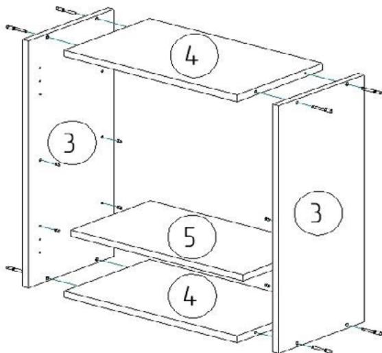
1. Соедините детали 3, 4 с помощью винтов евро 7х50 мм.
