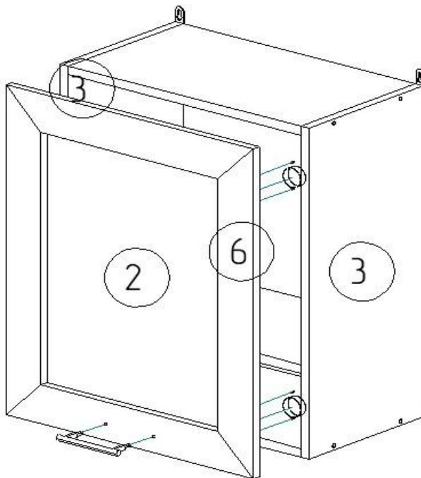
5. Закрепите ответные планки петель на деталь 3 (зависит ототкрывания фасада) и петли накладные на деталь 6 с помощью саморезов 4x16 мм.
