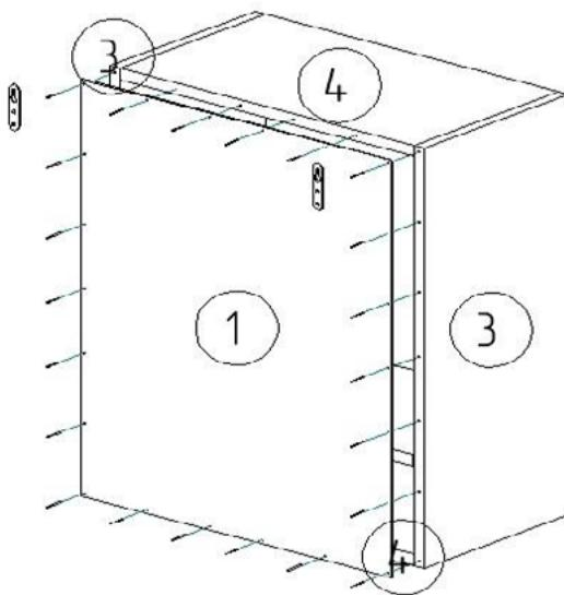
3. Закрепите деталь 1 на каркасе шкафа с помощью гвоздей 1,4x25 мм.
