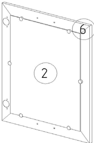
5. Закрепите деталь 2 на фасадной раме с помощью стеклодержателей и саморезов 4x16.
