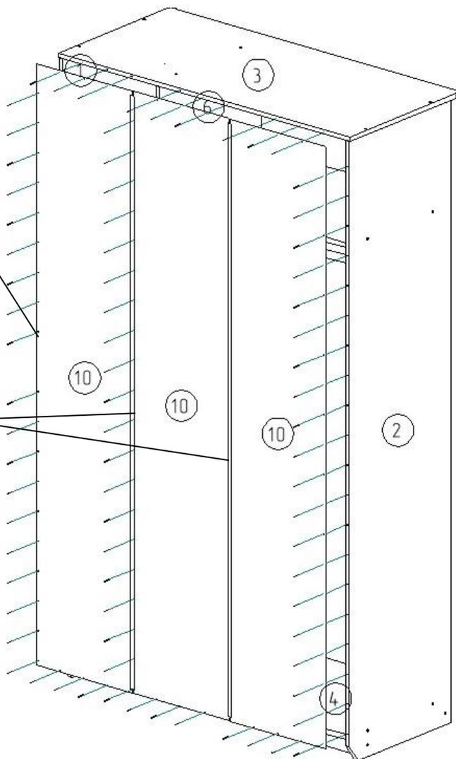
7. Закрепите детали 10 на каркасе шкафа с помощью гвоздей 2,0x25 мм, предварительно соединив детали брусом соединительным.
