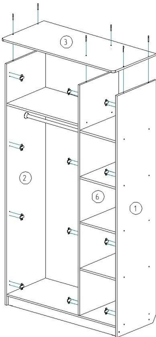
5. Соедините детали 1, 2, 6 с деталью 3 с помощью винтов евро 7x50 мм.
