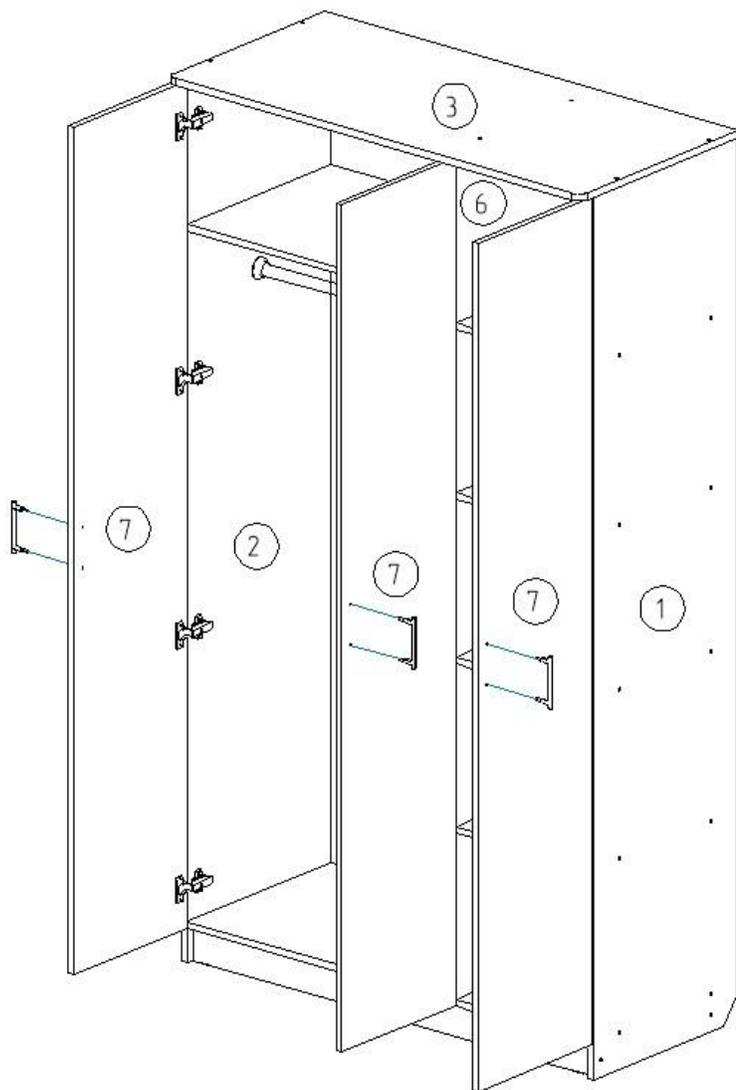
8. Закрепите петли накладные на детали 7 с помощью саморезов 4x16 мм.
