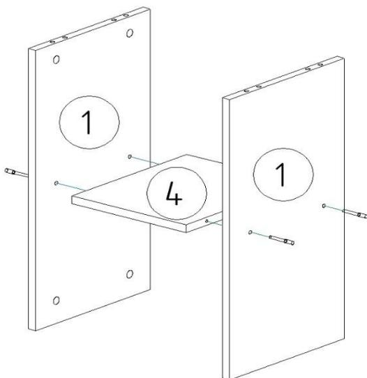
1. Соедините детали 1, 4 с помощью винтов евро 7x50 мм.
