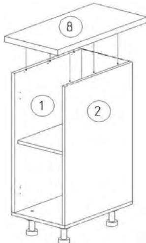
5. Соедините деталь 8 с деталями 1, 2 с помощью уголков пластиковых и саморезов 4x16 мм, 4x25 мм.
