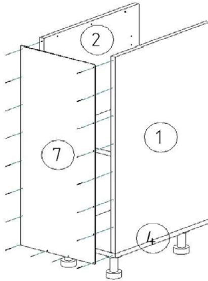
4. Закрепите деталь 7 на каркасе тумбы с помощью гвоздей 1,4x25 мм.
