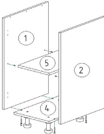
2. Соедините детали 1, 2 с деталью 4 с помощью винтов евро 7x50 мм.
