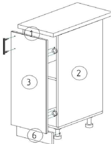
6. Установите на деталь 6 клипсы + планки, планки закрепите с помощью саморезов 4x16 мм, затем защелкните клипсы на опорах.
