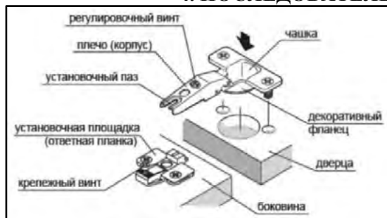
Рис. 1 Установка петель (установка на саморезы 4x16 мм)
