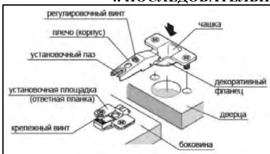
Рис. 1 Установка петель (установка на саморезы 4x16 мм)
