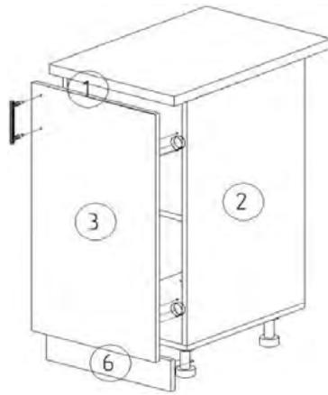
6. Установите на деталь 6 клипсы + планки, планки закрепите с помощью саморезов 4x16 мм, затем защелкните клипсы на опорах.
