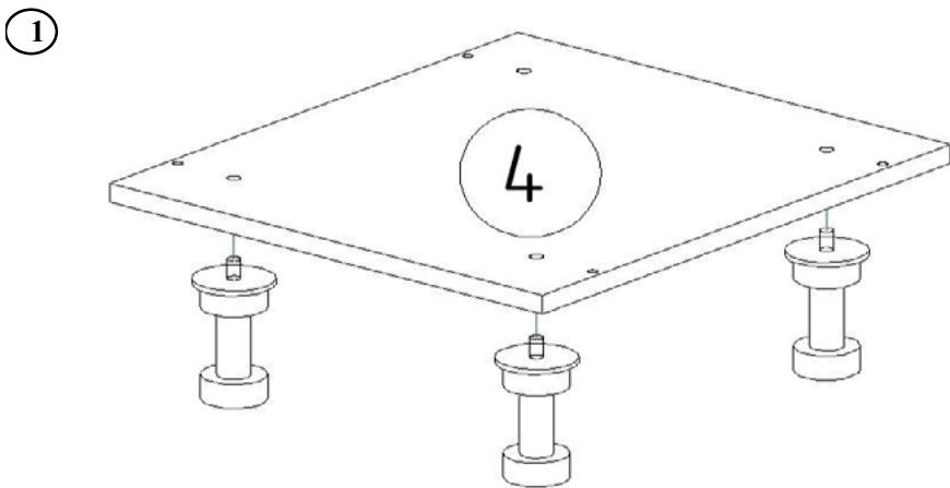
1. Установите на деталь 4 опоры с помощью саморезов 4x16 мм.
