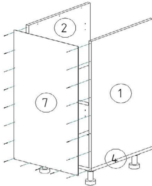
4. Закрепите деталь 7 на каркасе тумбы с помощью гвоздей 1,4x25 мм.
