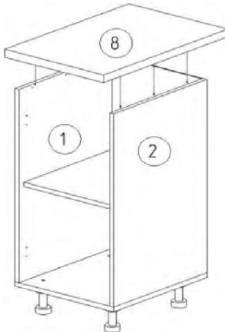
5. Соедините деталь 8 с деталями 1, 2 с помощью уголков пластиковых и саморезов 4x16 мм, 4x25 мм.
