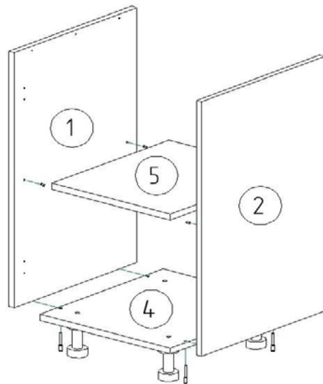
2. Соедините детали 1, 2 с деталью 4 с помощью винтов евро 7x50 мм.
